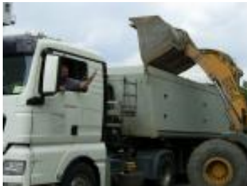
Foto 2 – Cuando se alcanza el peso máximo, la función de alarma avisa. El resultado es la carga máxima permitida por la normativa legal a la primera.
