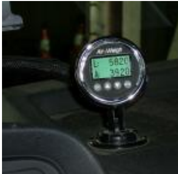
Bild 3 - Das Gewicht stets im Griff: Auf einen Blick sieht der Transportunternehmer den Lastzustand seines Fahrzeuges. Die Messgenauigkeit des LoadMaxx-Systems liegt bei 99,77 %. (d.h. eine Abweichung von unter 90kg bei 40t)
