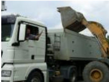
Bild 2 - Wenn das Gesamtgewicht erreicht ist, wird durch die Alarmfunktion der Ladevorgang abgebrochen. Dies führt zur höchstmöglichen Auslastung im Rahmen der gesetzlichen Vorschriften.
